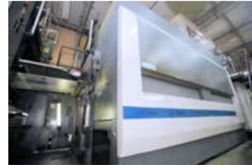
丸塚オフリン工場では、印刷後、インキを熱風乾燥します。
