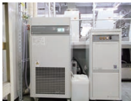
湿し水循環装置と高性能フィルター過装置
