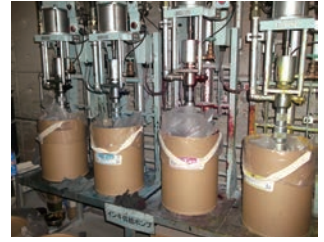
インキ供給ポンプによって配管を通して印刷機械に自動供給する装置
