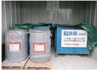
VOC発生抑制のため活性炭シートと荷台シートを活用
