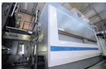
印刷後、インキを熱風乾燥及び脱臭する乾燥脱臭装置
