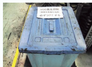
廃ウエスBOXの蓋はしっかりと閉められて、VOC発生抑制対策がされていました
