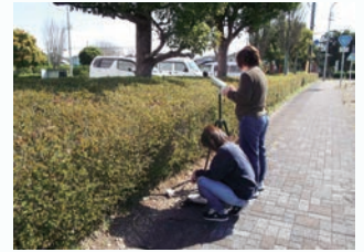
自主測定: 敷地境界線騒音・振動測定
